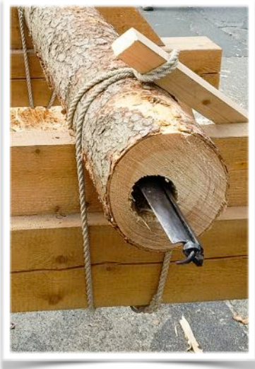
Bild 5: Herstellung aus einem gebohrten Holzstamm (Quelle: Jochen Wünscher)
